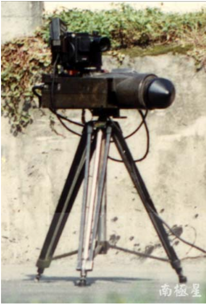
瑞製 MULTANOVA 6F Ka 頻雷達系統
