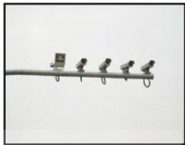
天网压线照相系统
