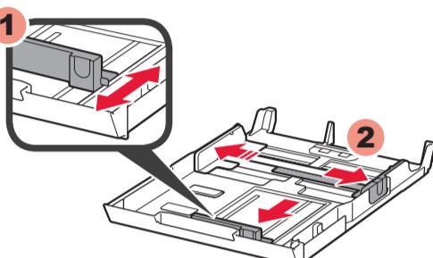
② 调整前端纸张导片以适合A4尺寸。
