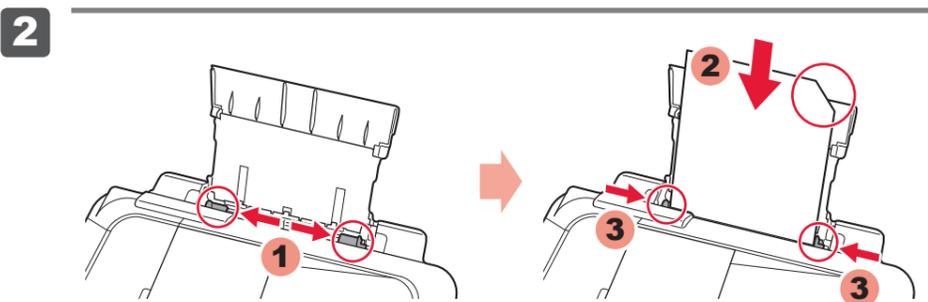
2 滑动纸张导片到两端。装入附带的MP-101纸张，然后调整纸张导片以适合纸张宽度。
