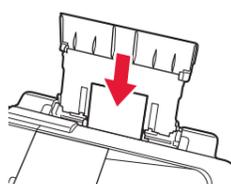
仅将照片纸装入后端托盘。使用照片纸时，应调整介质类型和尺寸的本机设置。有关详细资料，请参阅随后安装的手册。
