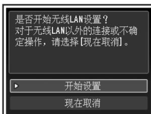
要连接到无线LAN，选择屏幕上的开始设置，然后按照屏幕上的说明操作。
