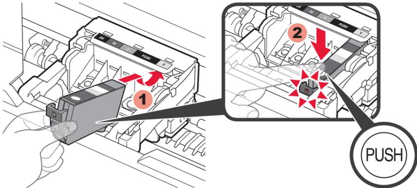
4 将墨水盒插入并向下推动至匹配颜色插槽。确认墨水指示灯亮起，然后安装下一个墨水盒。
