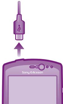
！ 确保在从手机拔出连接线时不要弄弯接头。
