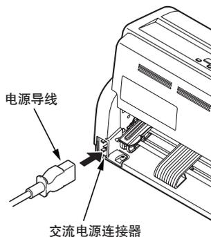
**3** 将电源线的插头正确插入到 AC 220V~240V 的插座中。
