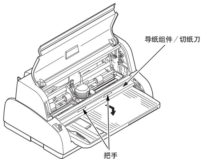
**6** 将色带盒两端的支脚插入打印机的 U 型沟部，直至其吻合不动为止。
