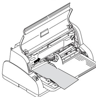
刚打印后，打印头及其周围的温度很高，因此请勿触摸打印头等。
