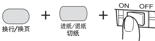
**3** 如果“联机”指示灯闪烁，则在按住“换行/换页”开关的同时，按下“联机”开关。
