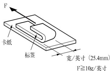
此粘度为大致标准，必须使用可以使标签在打印或送纸时保持不剥落状态的打印纸。
