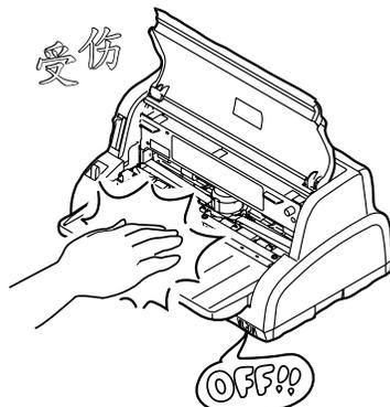
切勿在接通电源的状态下打开机壳更换色带盒等。打印机可能会突然启动，导致受伤。
