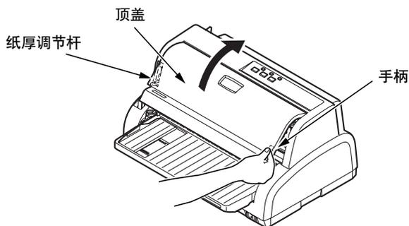
**4** 向外拉导纸组件两侧把手，使导纸组件进入锁定位置。
