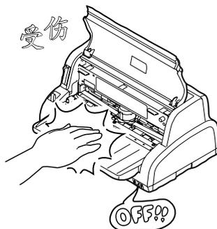
切勿在接通电源的状态下打开机壳进行操作。
