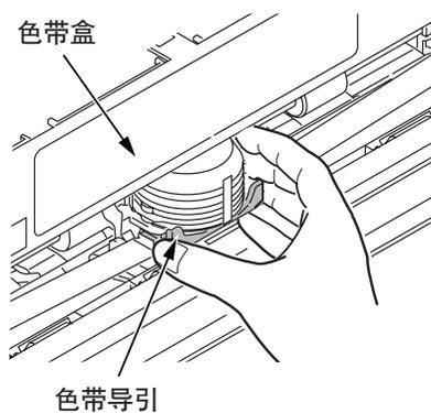
**6** 将色带盒的两侧向前拉出，解除锁定，并将整体按箭头取下。
