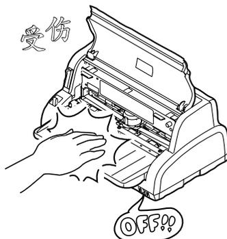
切勿在接通电源的状态下打开机壳进行操作。打印机可能会突然启动，导致受伤。
