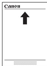
装入信封时，请将信封打印面朝上并先将右边缘（即靠近邮票侧）装入手送纸盘。
