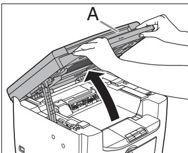
**3** 利用凹入部分上方的突起 (A) 打开打印机盖 (B)。
