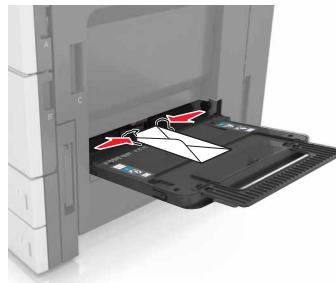
**警告—可能的损坏：**永远不要使用带有邮票、卡扣、摁扣、窗口、涂层或自动粘胶的信封。这些信封可能会严重损坏打印机。
