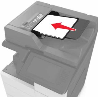
• ADF 用于多页或两面的文档。<br>• 面朝上加载原始文档。 |
