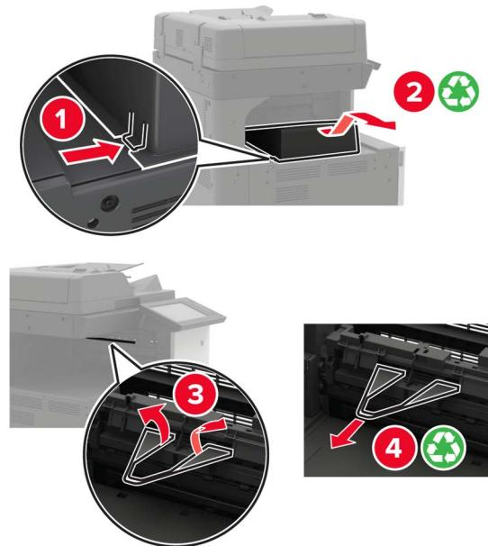
6 使用存储在盖门 A 内部的螺丝起子移除纸张导片。
