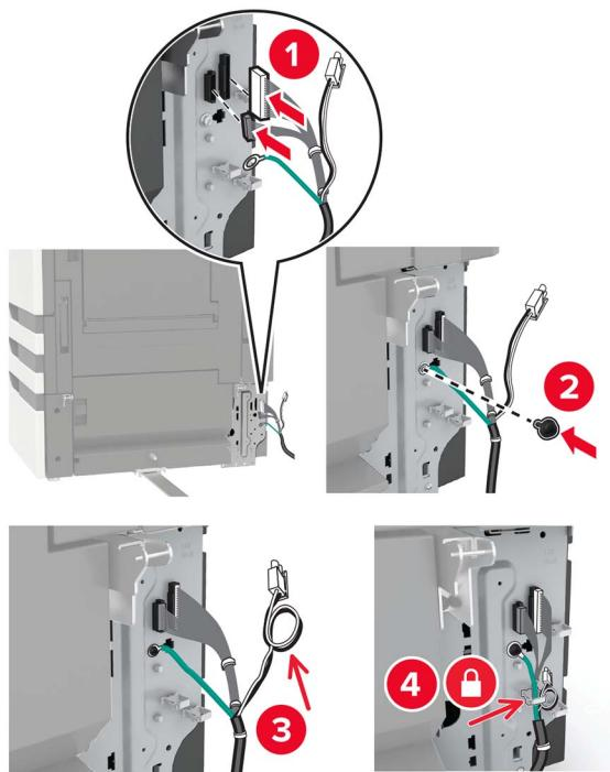
**19** 安装进纸匣电缆盖板。
