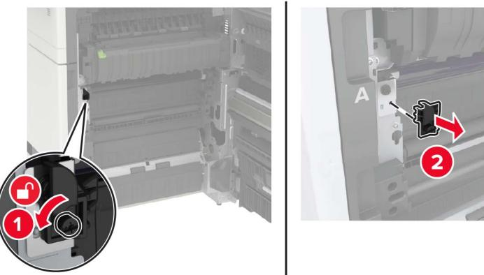
4 松开固定转印带的螺钉。
