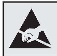
此符号指出静电敏感的部件。在没有先触摸远离该符号的区域内的金属表面时，不要接触靠近这些符号的区域。
