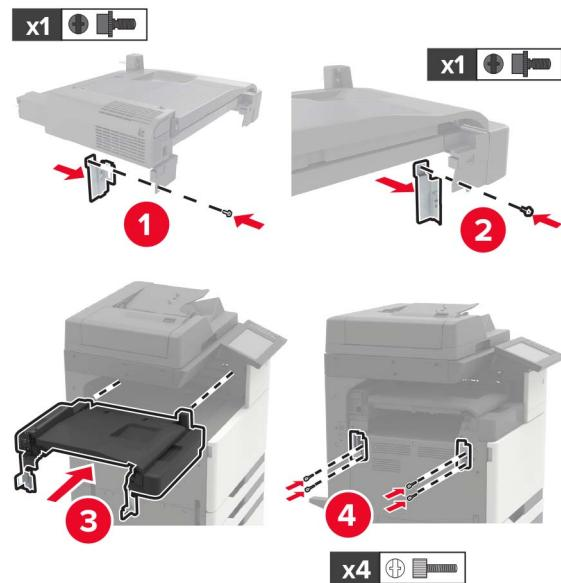
8 将完成器连接到打印机上。
