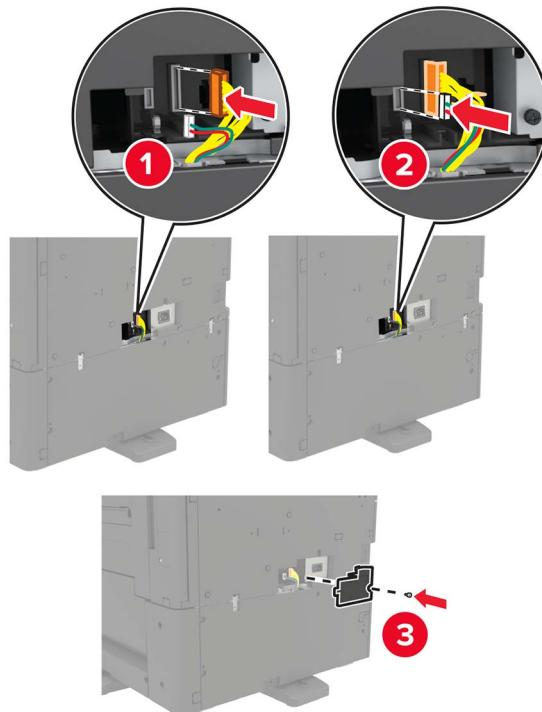
23 打开进纸匣 2 和 3，然后使用锁定夹和金属支架将 2 x 500 或 2500 页进纸匣固定到打印机上。
