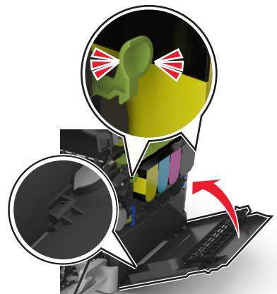
**9** 滑动并按住打印机右边的释放插销，然后缓慢地关闭顶部盖门。
