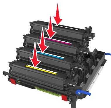
**注意:** 确认每个显影部件都被插入相匹配的颜色插槽中。
