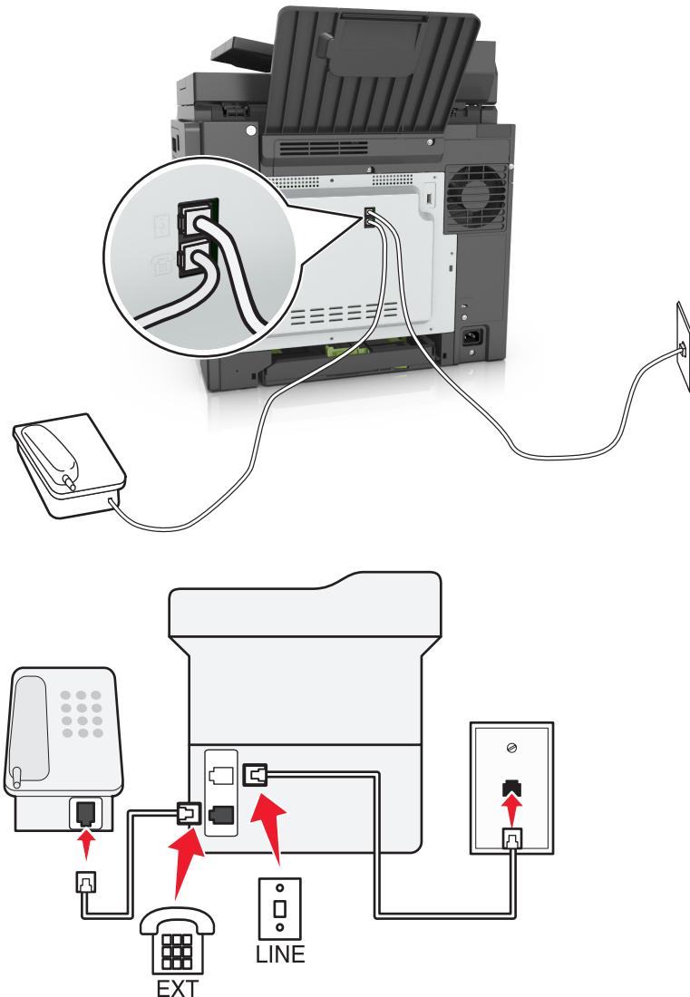
1 将随打印机附带的电话线的一端连接到打印机的 端口。
