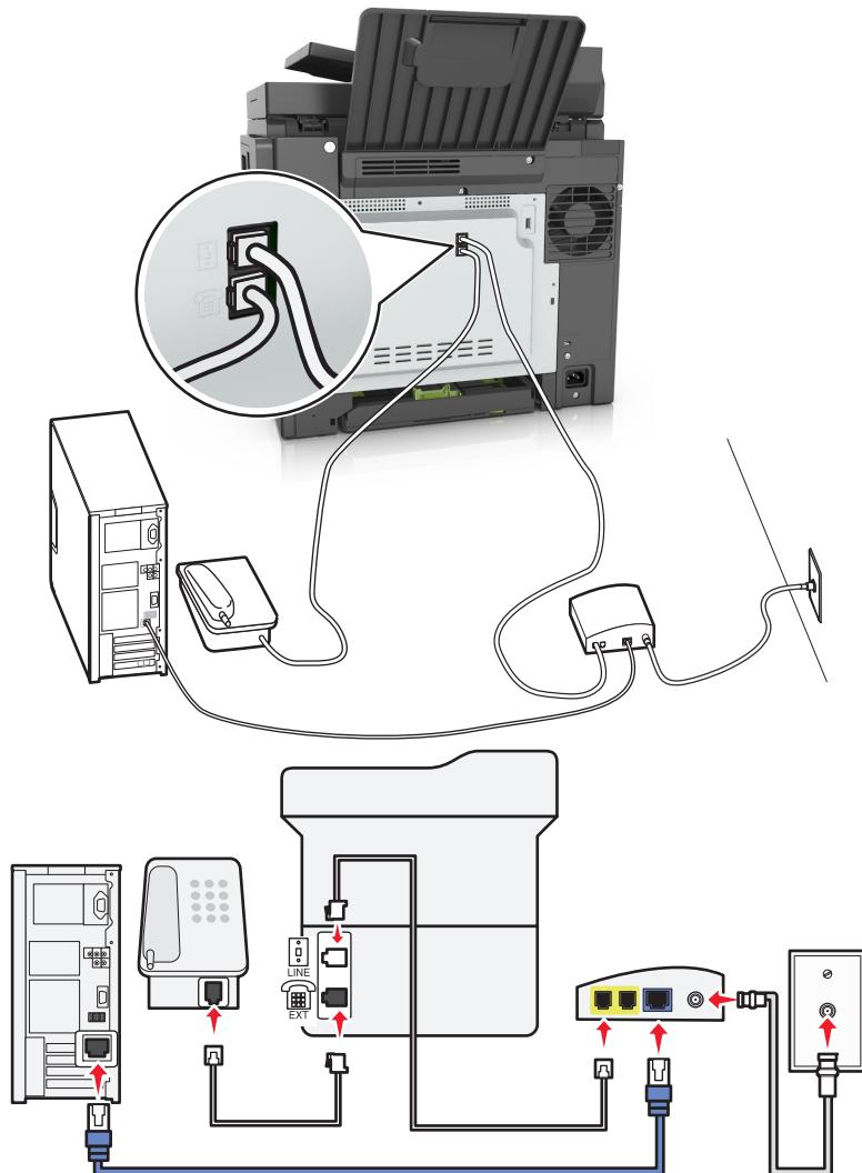
1 将随打印机附带的电话线的一端连接到打印机的 端口。
