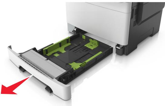
**2** 如果纸张长度大于 letter 尺寸的纸张, 请压住, 然后滑动进纸匣后部的长度导片来延伸它。
