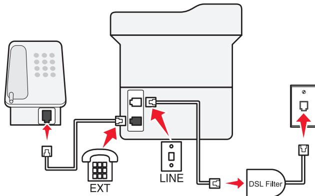
“数字用户线”将您的常规电话线路分为两个通道：语音和 Internet。电话和传真信号通过语音通道传输，而 Internet 信号通过另一个通道传输。这样，您可以使用同一条线路进行模拟语音呼叫（包括传真）和数字 Internet 访问。
