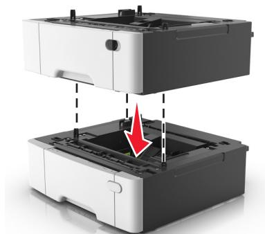
**4** 将打印机与 650 页双层进纸匣对齐，然后将打印机向下放到位。
