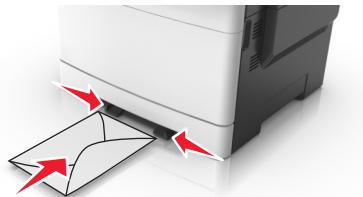
**2** 将纸张送入手动进纸器时，只让它的引导边可以接触到纸张导片。
