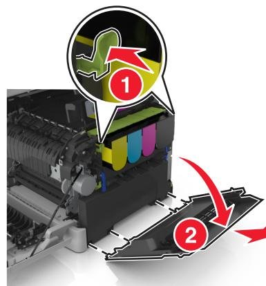
5 按废碳粉瓶两边的绿色控制杆，然后移除废碳粉瓶。
