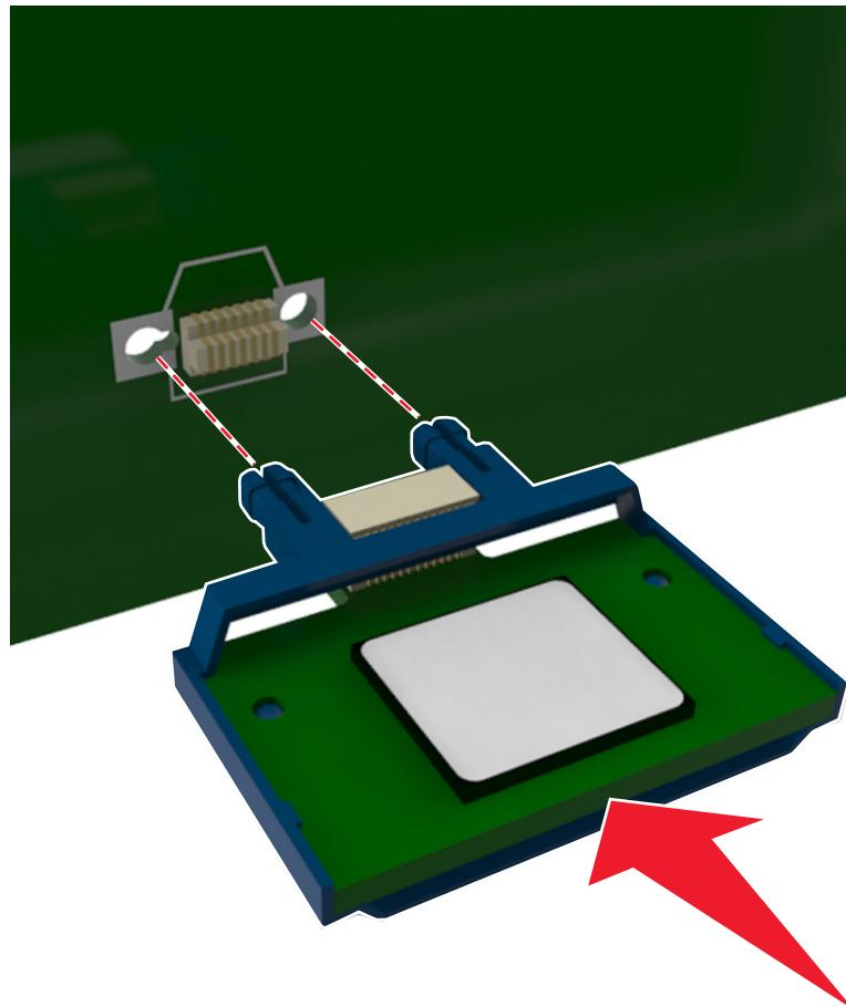
**警告—可能的损坏：**不正确安装卡可能造成卡和控制器板的损坏。
