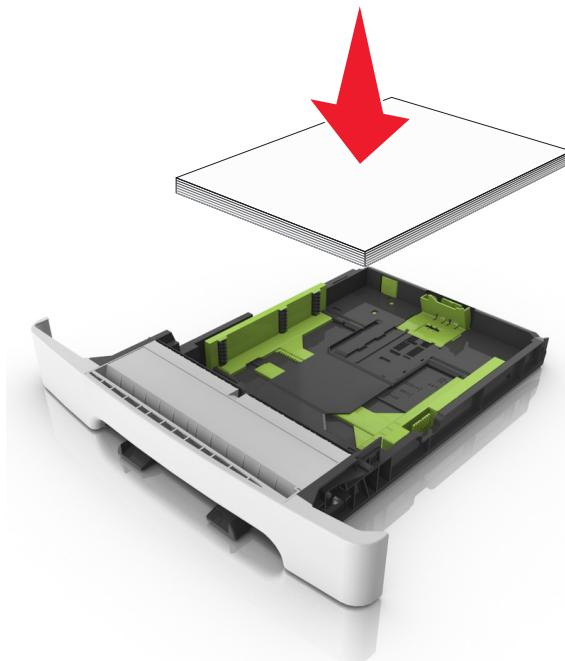
**7** 将纸张导片妥善地靠着纸张的边缘。
