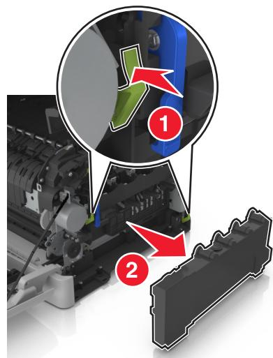
6 抬起成像组件上的蓝色控制杆，然后拉成像组件，直到停止。
