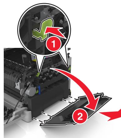
5 按废碳粉瓶两边的绿色控制杆，然后移除废碳粉瓶。
