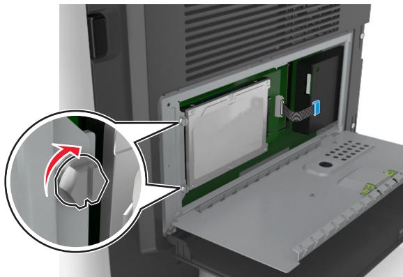
4 关闭控制器板挡板，然后关闭控制器板通道盖门。
