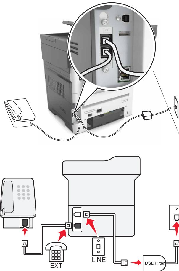
数字用户线 (DSL) 将您的常规电话线路分为两个通道：语音和 Internet。电话和传真信号通过语音通道传输，而 Internet 信号通过另一个通道传输。
