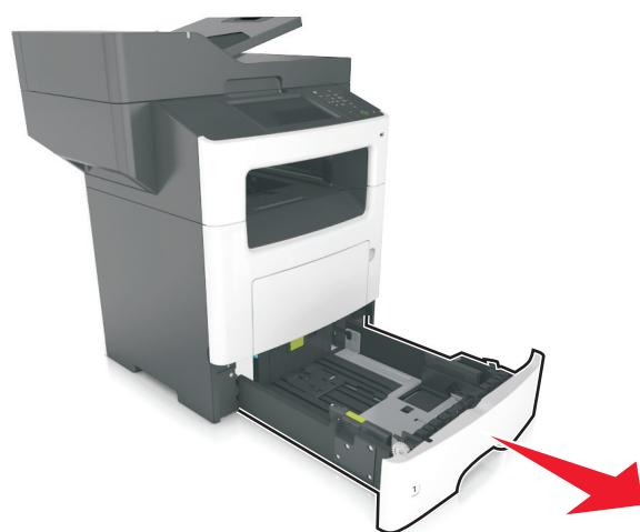
**2** 压住宽度导片凸柱，然后将它滑动到与您加载的纸张尺寸相符的正确位置上。
