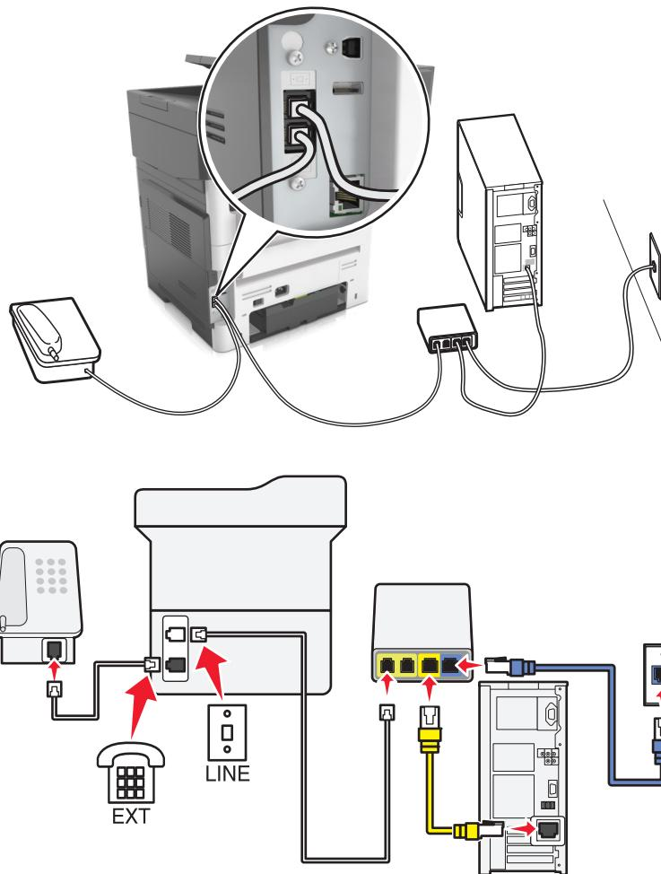
1 将电话线的一端连接到打印机的线路端口。
