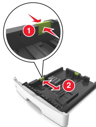
3 压住长度导片凸柱，然后将它滑动到与您加载的纸张尺寸相符的正确位置上。
