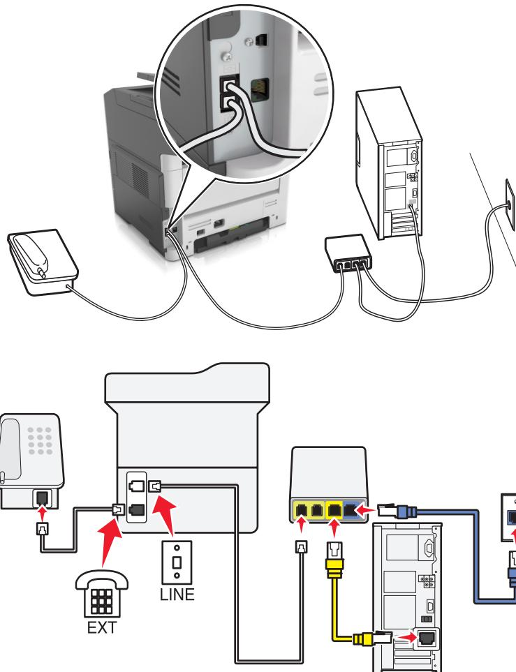
**1** 将电话线的一端连接到打印机的线路端口。
