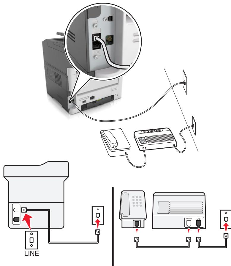
**1** 将电话线的一端连接到打印机的线路端口。
