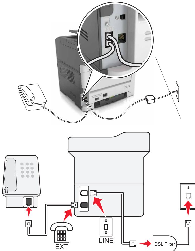
数字用户线 (DSL) 将您的常规电话线路分为两个通道：语音和 Internet。电话和传真信号通过语音通道传输，而 Internet 信号通过另一个通道传输。
