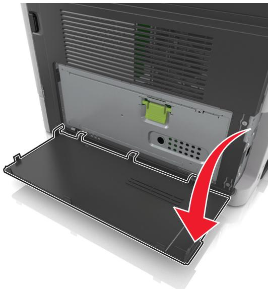
2 使用绿色手柄打开控制器板挡板。
