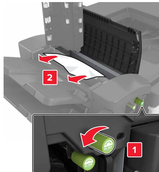
**注意:** 如果在完成器接纸架之间有卡住的纸张, 请移除纸张。
