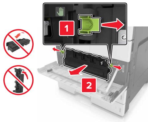
**3** 清洁充电辊和打印头镜片。如需更多信息，请参阅第 118 页上的“[清洁充电辊和打印头镜片](#)”的第 3-7 步。
