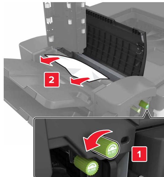
**注意:** 如果在完成器接纸架之间有卡住的纸张, 请取出纸张。
