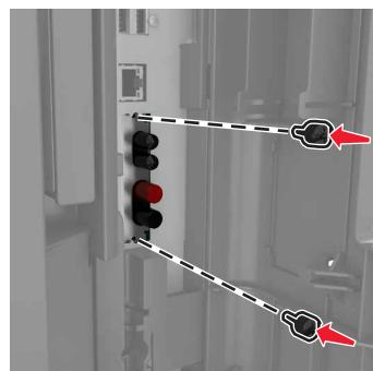
7 将 ISP 接口电缆的插头插入控制器板的连接器中。
