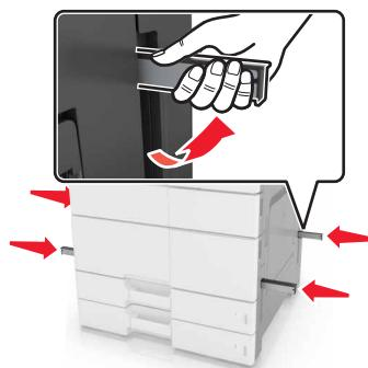
7 将打印机与进纸匣对齐，然后将打印机向下放到位。
