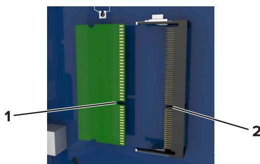
**4** 将内存卡笔直推入连接器中，然后将卡朝着控制器板墙推，直到它发出“喀”一声，卡入到位。
