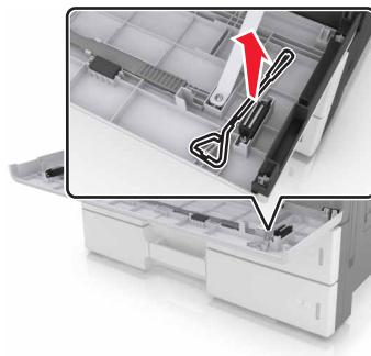
控制器板支持一个可选的 Lexmark 内置方案端口 (ISP)。请安装 ISP 以获得额外的连通性选项。
