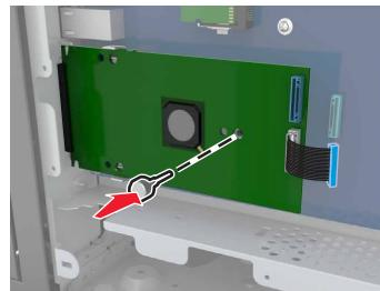
6 使用螺钉将 ISP 安装支架安装到控制器板罩上。
