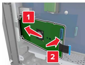
5 使用翼形螺钉将支架连接到 ISP 上。
