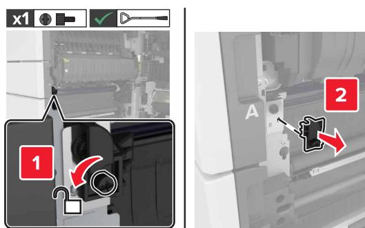
4 松开转印模块锁的螺钉。
