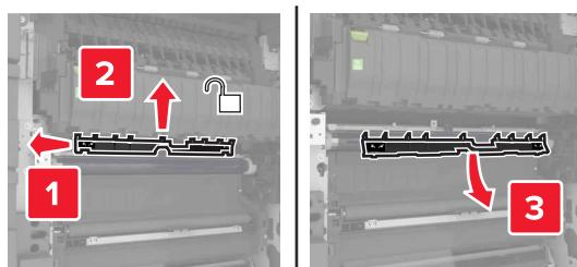
6 使用手柄抬起转印模块，然后将它完全拉出。
