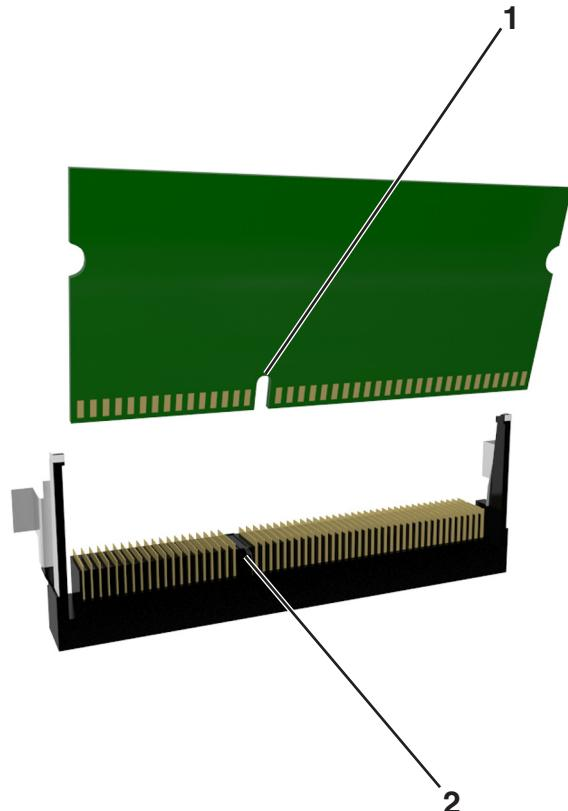
**4** 将内存卡笔直推入连接器, 并将它向前推入控制器板墙中, 直到它发出“咔嗒”一声, 卡入到位。
