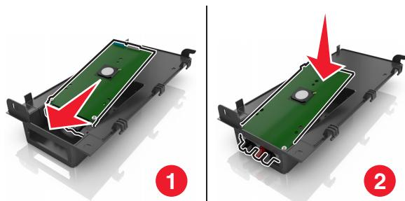
6 使用长螺钉将 ISP 解决方案固定在塑料支架上。
