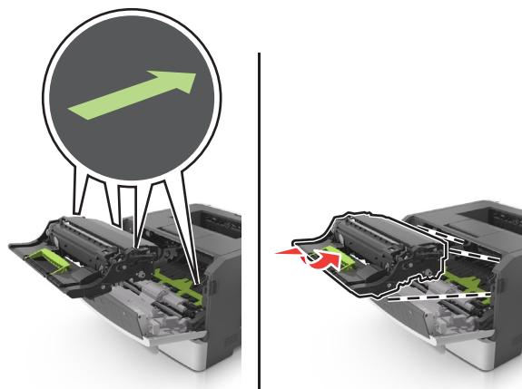
7 将碳粉盒的侧导轨与打印机内部侧导轨上的箭头对齐，然后将碳粉盒插入打印机中。
