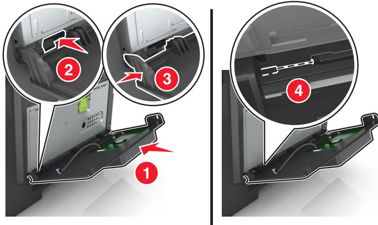
10 将 ISP 电缆穿过控制器板挡板盖门。
