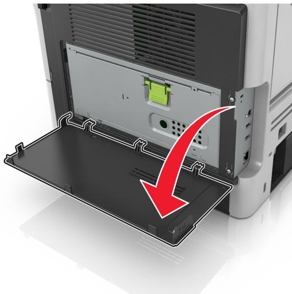
**2** 轻轻按通道盖门右边的制动片，然后滑动通道盖门以移除。
