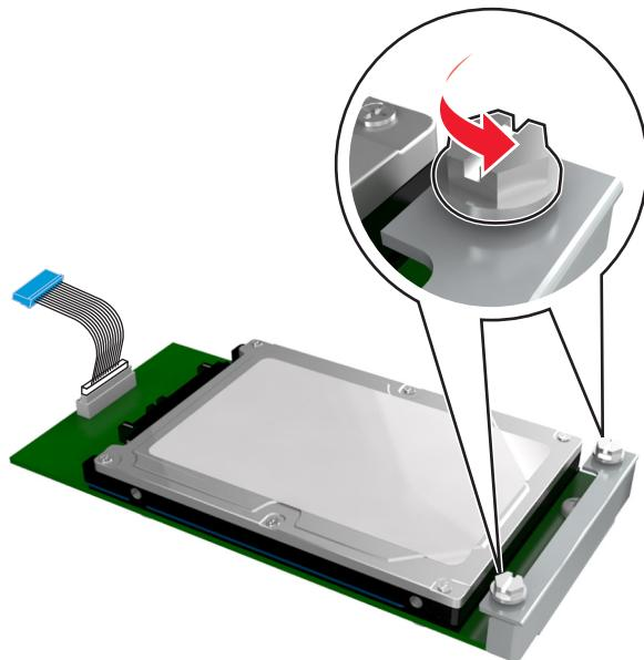
b 将打印机硬盘上的螺钉与控制器板支架上的凹槽对齐，然后将打印机硬盘滑入支架。
