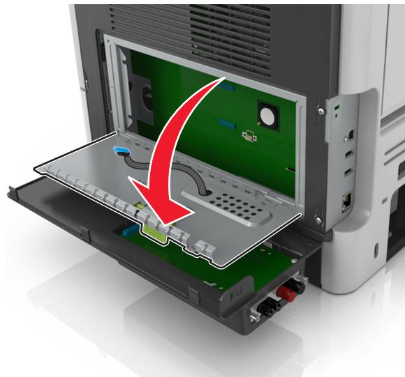
**12** 将 ISP 解决方案接口电缆的蓝色插头连接到控制器板上的蓝色插座中。
