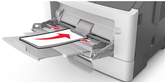
**警告—可能的损坏：**永远不要使用带有邮票、卡扣、摁扣、窗口、涂层或自动粘胶的信封。这些信封可能会严重损坏打印机。
