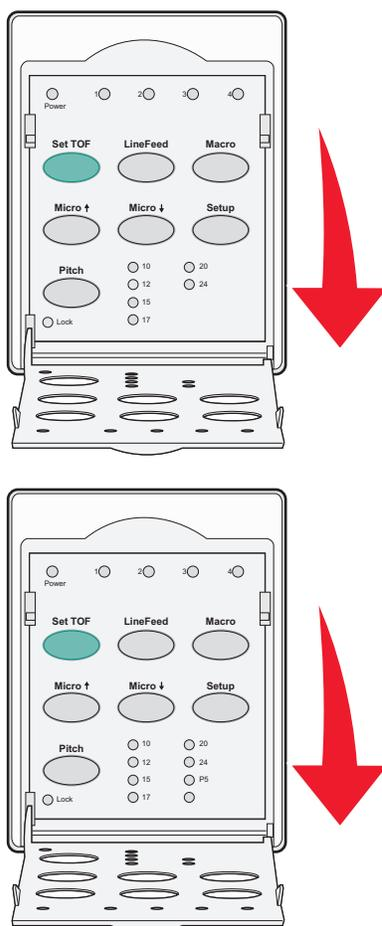
**2** 按“设置”以将打印机置于“设置”模式并打印主菜单。
