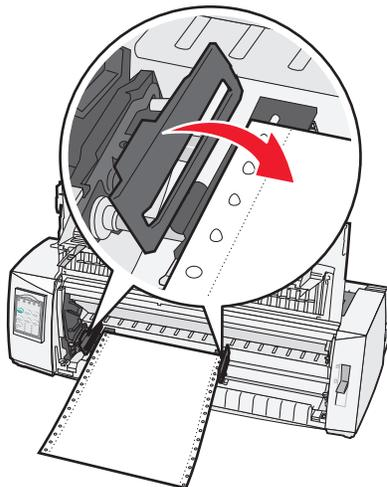
9 移动拖纸器以将纸张的左边距与后板上印制的 [A] 符号对齐。
