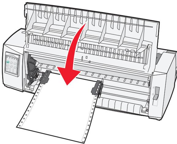
13 按“启动/停止”以将纸张装入到页顶，然后使打印机联机。
