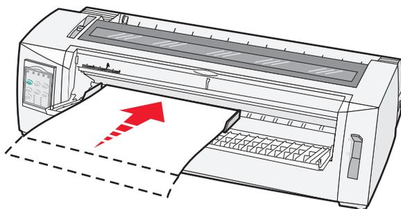
7 继续将纸张推入打印机中，直至“缺纸”指示灯停止闪烁。
