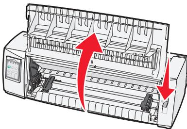
6 在按住滑锁杆的同时，将左侧和右侧锁止装置固定到打印机中的接线柱上。
