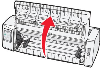
4 将拖纸器抬起并从打印机中拉出时，按住滑锁杆。
