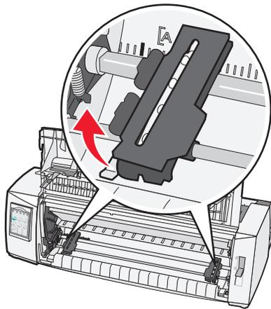
7 打开左右拖纸器盖板，然后将纸张孔眼放在拖纸器单位的第二或第三个插销上。
