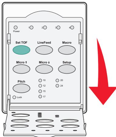
5 按任何纸张移动按钮（细微↑、细微↓、“换行”）以将位于滚筒上的水平线与所需的页顶对齐。
