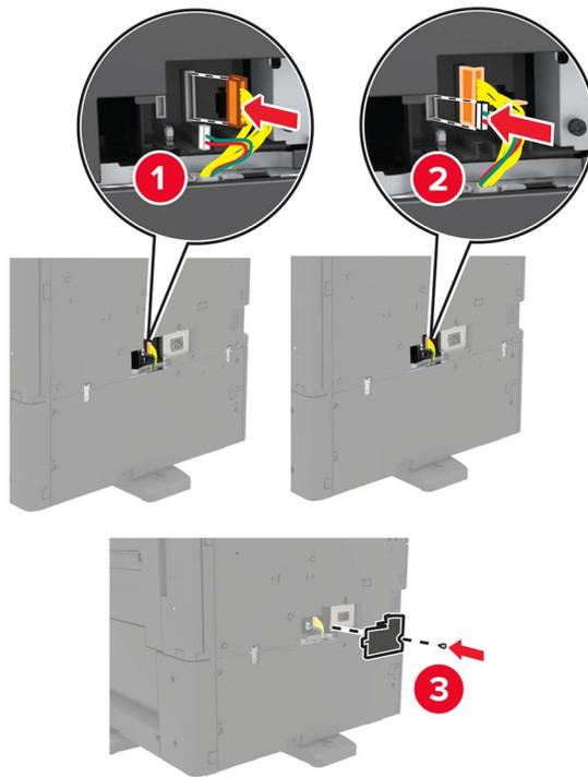
**23** 打开进纸匣 2 和 3，然后使用锁定夹和金属支架将 2 x 500 或 2500 页进纸匣固定到打印机上。
