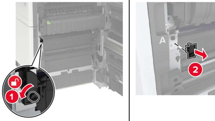
4 松开固定转印带的螺钉。
