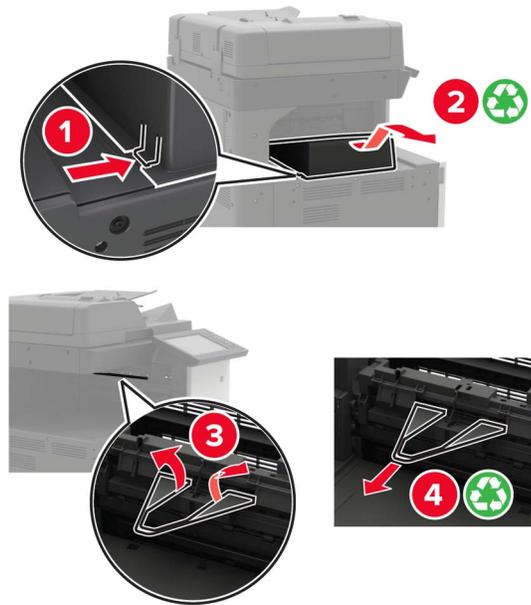
6 使用存储在盖门 A 内部的螺丝起子移除纸张导片。
