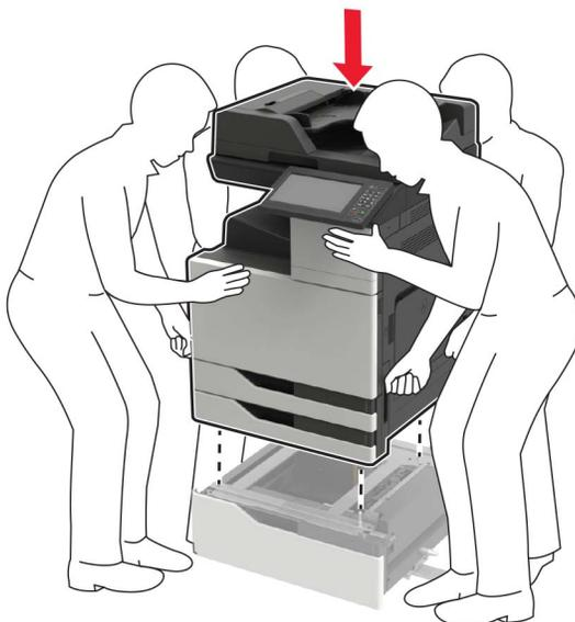
16 将 3000 页进纸匣与打印机对齐，然后安装固定柱。
