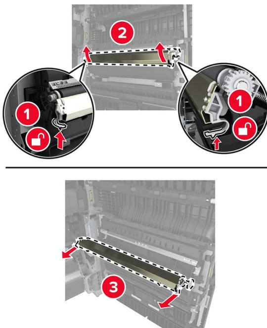
3 拆开新转印辊的包装。
