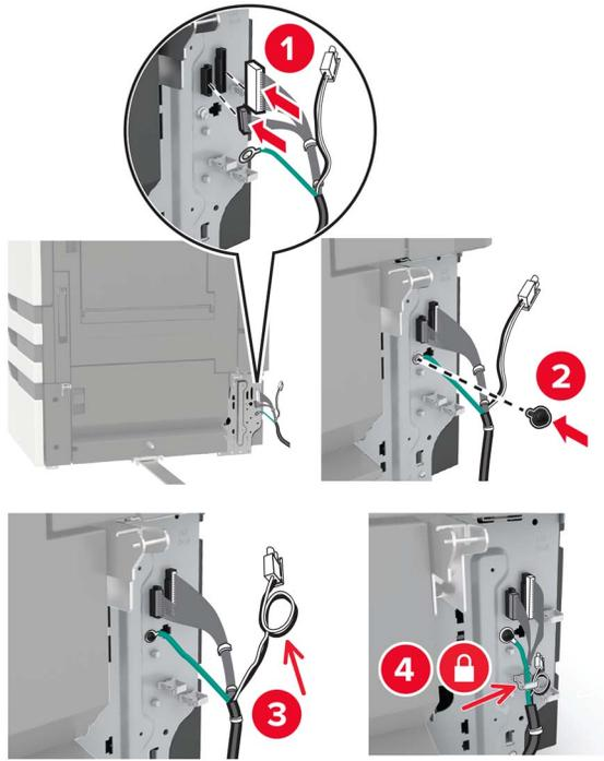
**19** 安装进纸匣电缆盖板。
