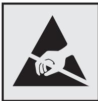
此符号指出静电敏感的部件。在没有先触摸远离该符号的区域内的金属表面时，不要接触靠近这些符号的区域。
