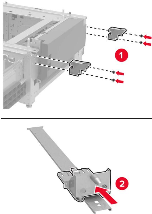
**13** 安装导轨，然后安装安装支架和导轨盖板。
