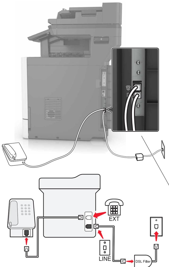
数字用户线 (DSL) 将您的常规电话线路分为两个通道：语音和 Internet。电话和传真信号通过语音通道传输，而 Internet 信号通过另一个通道传输。
