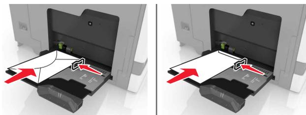
**警告—可能的损坏：**不要使用带有邮票、卡扣、摺扣、窗口、涂层或自动粘胶的信封。
