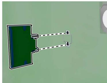
**注意:** 卡上的整个连接器必须完全接触控制器板，并平整地挨着控制器板。
