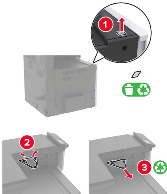
6 使用存储在盖门 A 内部的螺丝起子移除纸张导片传感器和滑轨的盖板。
