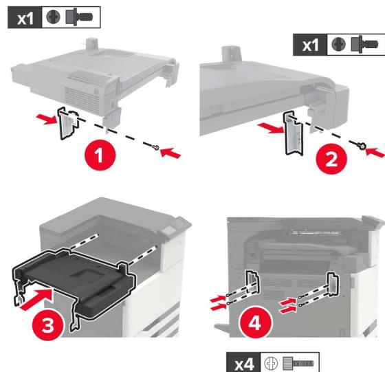
8 将完成器连接到打印机上。
