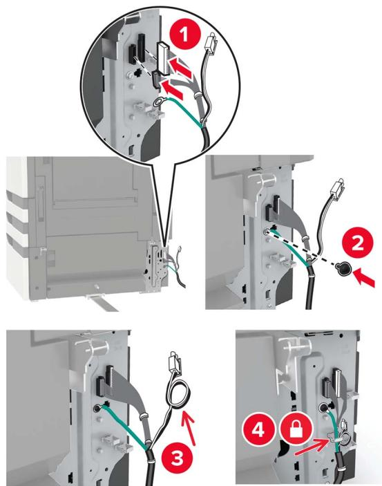
**19** 安装进纸匣电缆盖板。
