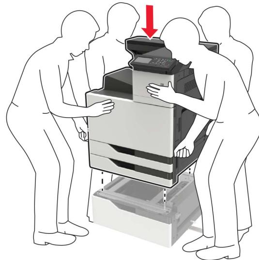
**16** 将 3000 页进纸匣与打印机对齐，然后安装固定柱。
