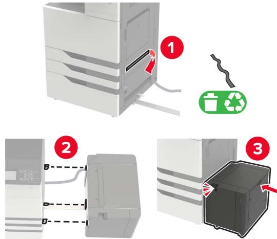
**21** 将稳定脚安装到打印机上。
