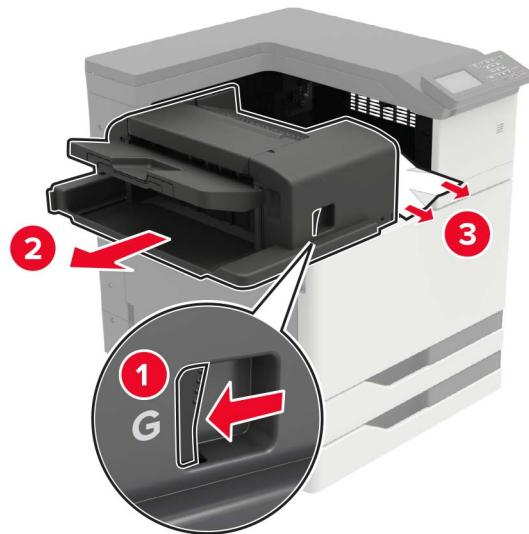
如果需要，向下转动转轮 G1 以将被卡的纸张送入完成器接纸架中，然后取出被卡的纸张。
