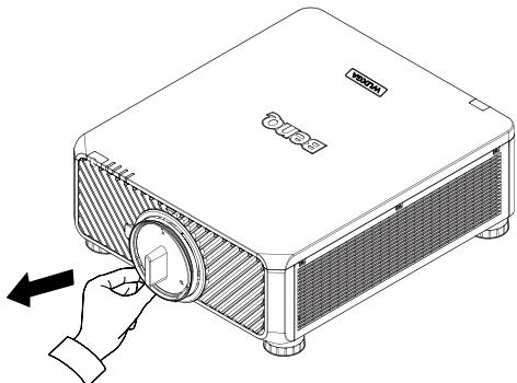
2. 从下面标示的箭头方向插入镜头，然后顺时针旋转镜头，直至听到咔哒两声。
