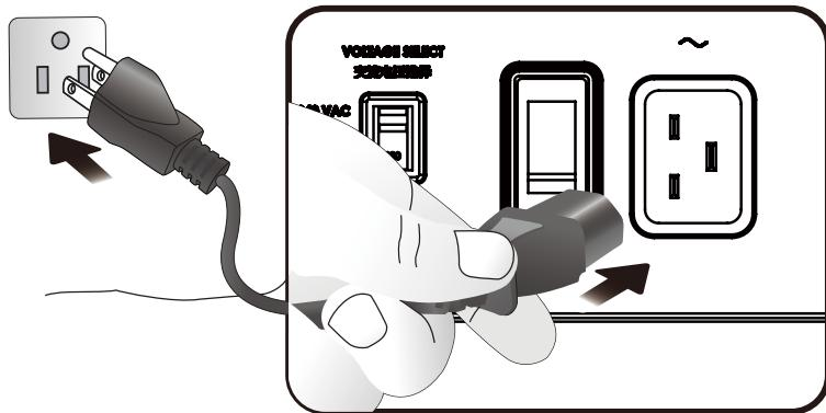
在打开电源开关之前，请确保在投影机所使用地区选择正确电压的电压开关。
