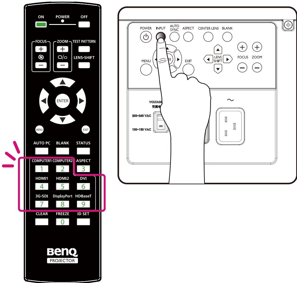
2. 按 ENTER 键确认输入选择，它会需要几秒才能检测到所需的输入信号和显示投影图像。
