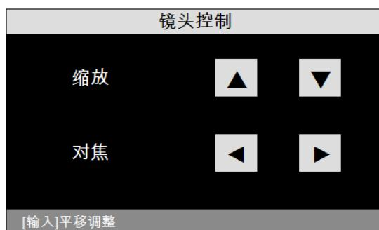
1. 按投影机上的 LENS SHIFT 键或遥控器上的 LENS SHIFT 键以弹出“镜头移位”窗口。
