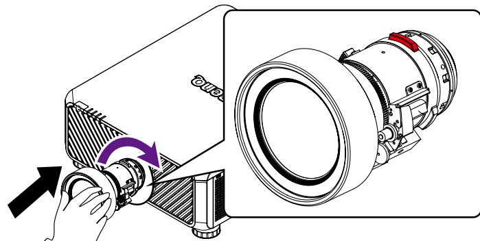
3. 使用防盗螺丝以防止镜头被盗。拧紧前面下部附带的防盗螺丝。
