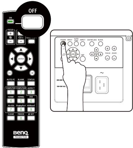
2. 再次按 POWER 或 OFF 按钮确认关机。冷却过程中电源 LED 闪烁橙色；投影机回到待机模式时电源 LED 亮起稳定红色。
