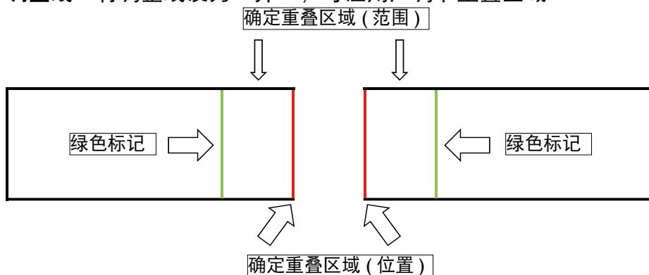
**白电平：**白电平用于调节融合的重叠区域。通过选择上下左右区域，可以将重叠区域优化为非重叠区域以显示无缝画面。将线条调整为另一台投影机的边缘像素线条。
