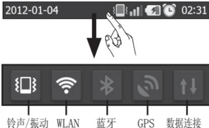
请使用手指点触并向下滑动通知器。或者在主屏中按**菜单键**
