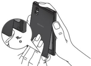
2. 将 USIM 卡滑进 USIM 卡插槽中。确保卡的金色接触区域面朝下。
