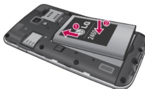
4 在电池仓上对齐电池盖，再向下按图示的 6 个位置直到其卡入到位。
