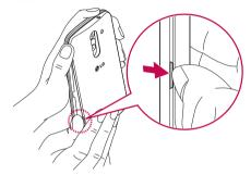
2 如圖所示將Micro-SIM卡滑人下方的Micro-SIM卡插槽。 確保 Micro-SIM的金屬接觸面朝下。
