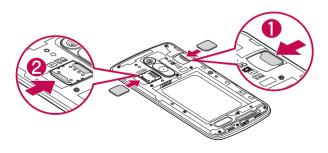
**3** 对齐手机与电池上的金色接触区域(1),向下按电池直到卡入到位(2),以插入电池。
