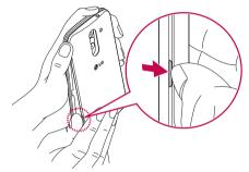
**2** 将Micro-SIM卡滑入下方的Micro-SIM卡插槽中,如图中所示。 确保卡的金色接触区域面朝下。
