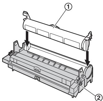
4 坚直接下墨盒（①）。将墨盒两侧上的控制杆在按下的同时，转向自身方向（②）。
