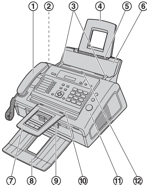
**① 话筒****② 扬声器****③ 文稿引导板****④ 载纸盘****⑤ 记录纸入口****⑥ 拉力板****⑦ 文稿支架<sup>\*1</sup>****⑧ 记录纸支架<sup>\*1</sup>****⑨ 记录纸出口****⑩ 文稿出口****⑪ 前盖****⑫ 文稿入口**
