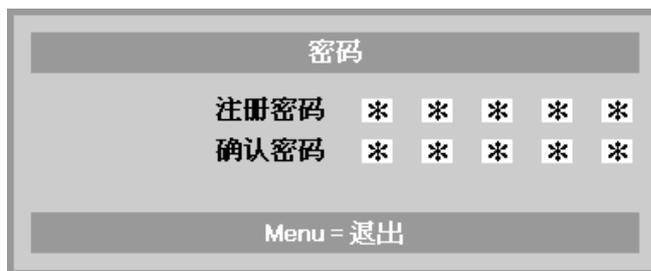
6. 如果**安全锁**已启用，则在按下投影机的电源按钮时，会提示用户输入密码。按照您在步骤 5 中设置的顺序输入密码。如果您忘记密码，请联系 InFocus。访问我们的网站 [www.infocus.com/support](http://www.infocus.com/support) 或致电我们。
