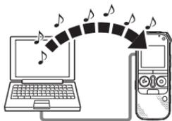
可以用拖放方式将MP3文件，从电脑复制到IC录音机上，并用IC录音机进行播放。
