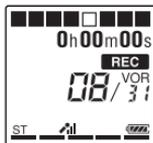
当未检测到任何声音时录音暂停，“PAUSE”闪烁。当IC录音机再次检测到声音时，再次开始录音。
