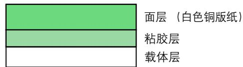
不干胶标签纸必须整个被其面层覆盖，各个标签之间没有空隙。标签之间若有空隙容易脱落，从而导致严重的卡纸故障。
