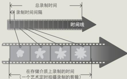
艺术定时拍摄功能通过录制的预定义时间间隔的图像帧超过总录制时间来产生定时拍摄的视频。
