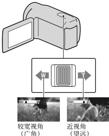
轻轻移动电动变焦控制杆可进行慢速变焦。较大幅度移动可进行快速变焦。
