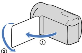
打开液晶屏幕, 与本机成90度 (①), 然后将其朝着镜头一侧旋转180度 (②)。
