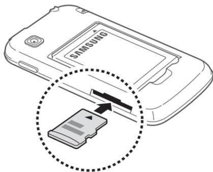
3 将存储卡推进存储卡槽，直至锁定到位。
