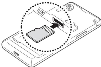
3 将存储卡推进存储卡槽，直至锁定到位。
