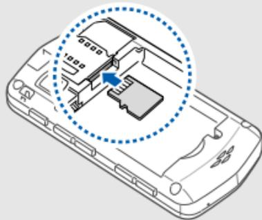
3. 将存储卡插入存储卡插槽，直到锁定到位为止。
