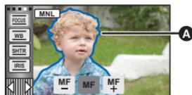
对准焦点的区域以蓝色显示。将被摄物体对准在焦点上约 2 秒后，会返回到标准屏幕。
