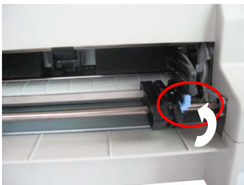
图 3-9 松开链轮锁定杆
