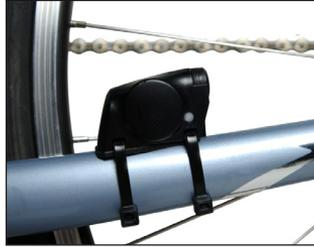
2. 迴轉速磁鐵的安裝，請先確認磁鐵上的感應線與GSC 10感應器接收面 (圓形突起處) 已對應，再利用束線帶將之綁在自行車踏板支架上。
