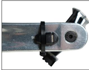
3. 輪圈轉速磁鐵的安裝，請安裝至輪圈的輪幅支架上，安裝前請確認裝設位置與GSC 10感應器的輪圈感應桿 (右側桿狀物) 於平行位置，再將磁鐵與
