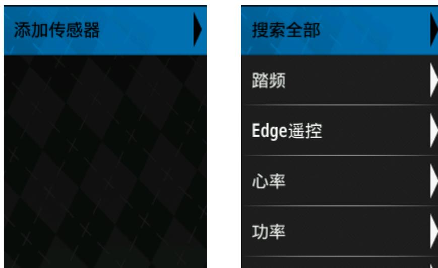
可搜寻到刚刚安装的传感器，勾选后完成配对
