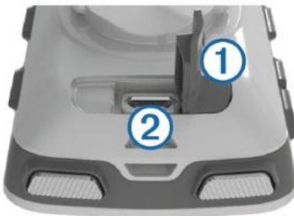
将 USB 连接线较小的一端接口插入接口。
