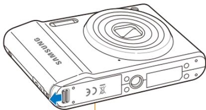
存储卡带有金色触点的一面朝下插入。
