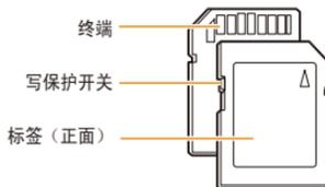
使用 SD 或 SDHC 存储卡上的写保护开关，可以防止删除文件。向下滑动写保护开关可将其锁定，向上滑动则可解除锁定。拍摄时，请解除存储卡锁定。
