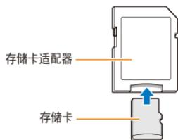
若要在本产品、电脑或者存储卡读卡器上使用微型存储卡，请将卡插入存储卡适配器中。
