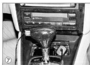
将汽车电源连接器插入点烟口
