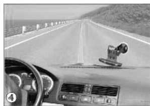
将吸盘吸在汽车前窗的适当位置
