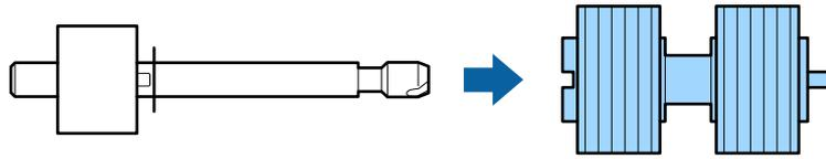
**18** 将新的分纸滚轮安装到轴上，确保凹槽对齐。
