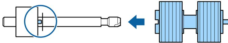
检查没有空隙。确保分纸滚轮完全套到轴上。
