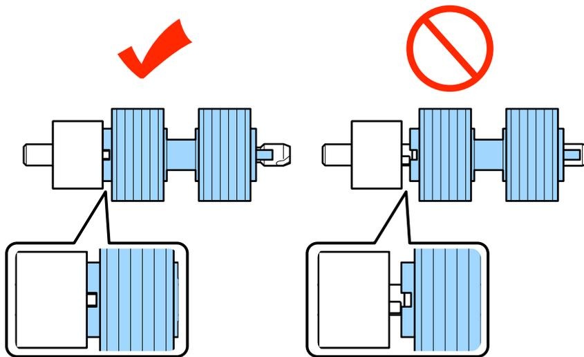
**19** 将新的分纸滚轮安装到正确的位置上。确保对准凹槽。
