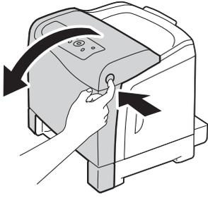
**5** 打开皮带组件直至其停止，然后移除卡住的纸张。确认没有纸片余留在打印机内。
