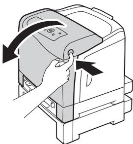
**5** 打开皮带组件直至其停止，然后移除卡住的纸张。确认没有纸片余留在打印机内。
