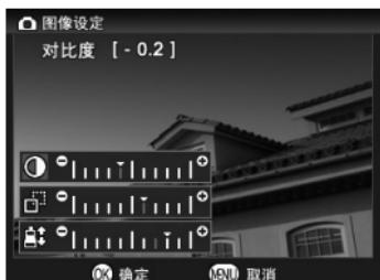
利用四方控制盤上的  $\blacktriangleleft$  箭頭方向，進入 [图像設定] 選單，選擇 [对比度], [清晰度], [饱和度] 選項，再利用  $\blacktriangleright$  箭頭方向，調節所須圖像設定。
