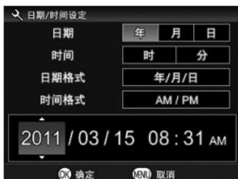
DP2X 可将时间和日期等资料纪录在每一幅图像内。为确保每幅图像资料纪录正确，请在第一次使用本相机时，需先行调较此相机内的时计。
