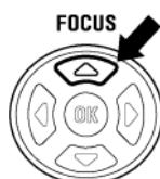
两款自动对焦模式可供选择：当在正常状态下(屏幕上不含代表符号)，对焦范围从 28cm 至无限远。而在 LIMIT 模式时，按下 FOCUS 键时 (▲符号实时显示于屏幕上)，对焦范围从 1m 至无限远，对焦速度将会加快。
