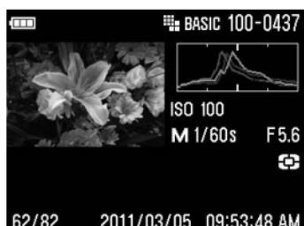
此矩形图 (Histogram) 显示一光暗平均数值，指示此图像之曝光正常，并有良好之对比。而一幅拥有良好曝光之图片是须要视乎被摄主体等不同因素。
