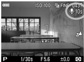
附声音图像 设定后，录音时间提示，即在 LCD 屏幕在上部显示。
