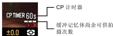
当相机处“优先拍摄”模式时，影像数据将在缓冲记忆体满载后开始进行处理。若在缓冲记忆体尚未满载时停止拍摄，影像数据将在早前经预设的时间后才开始启动进行处理。时间设定可在 [CP 时间设定] 选单中设定。
