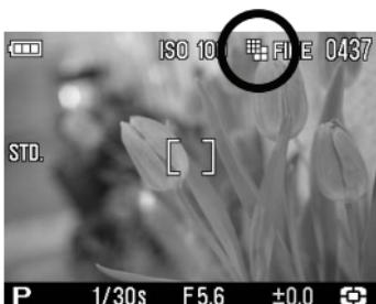
图像大小设定可利用快速选单设定 (P.34) 或 [拍摄设定] (P.26) → [图像容量]。
