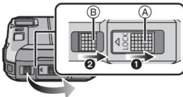
**2** 电池: 注意电池方向, 完全插入直到听到锁住的声音为止, 然后确认是否被开关③锁住。要想取出电池, 请朝箭头指示的方向滑开开关③。
