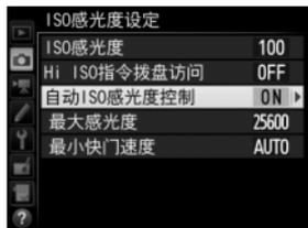
当选择了开启时，屏幕中将显示 **ISO AUTO**。若用户所选的感光度值发生变化，这些指示将闪烁，且变化后的数值将显示在控制面板中。
