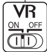
照相机稳固安装于三脚架时请关闭减震，但三脚架云台不稳固或使用单脚架时请将其开启。
