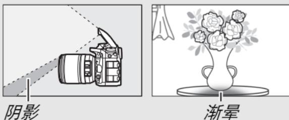
取下镜头遮光罩可防止阴影。有关适用内置闪光灯的镜头的详细信息，请参阅照相机的*菜单指南*，该指南可从以下网站下载：
