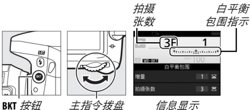
在 0 以外的设定下，**BKT** 和 **BKT** 分别显示在控制面板和取景器中；**WB-BKT** 图标和包围指示出现在信息显示中。
