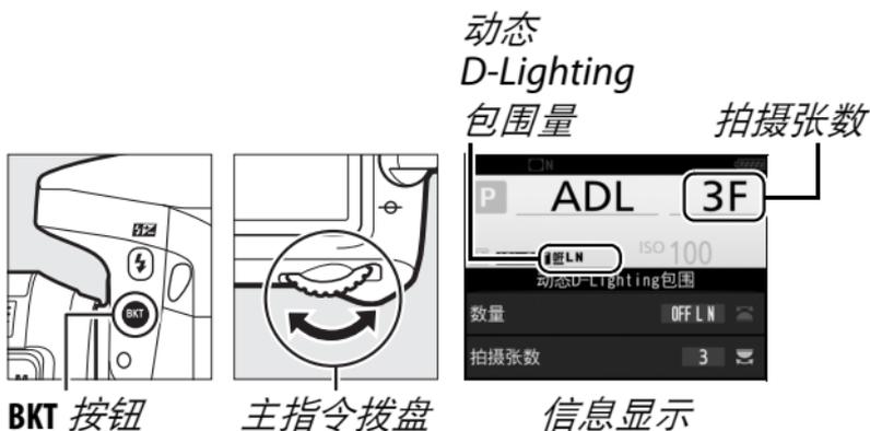
在 0 以外的设定下，**BKT** 和 **BKT** 分别显示在控制面板和取景器中；**ADL-BKT** 图标和包围量出现在信息显示中。
