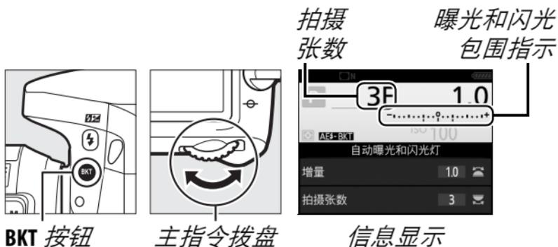
在 0 以外的设定下，控制面板中将显示 **BKT** 图标。取景器中将显示 **BKT**，信息显示中则提供包围指示以及表示包围类型的图标：**AE-BKT**（曝光和闪光包围）、**AE-BKT**（仅曝光包围）或 **BKT**（仅闪光包围）。
