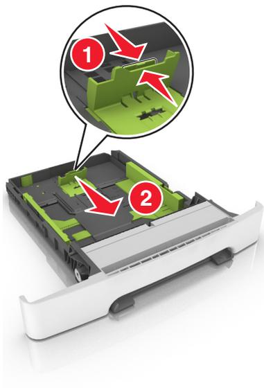
**注意：** 请使用进纸匣底部的尺寸指示器来帮助放置导片。
