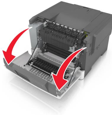
3 滑动打印机右边的释放插销，然后打开顶部盖门。
