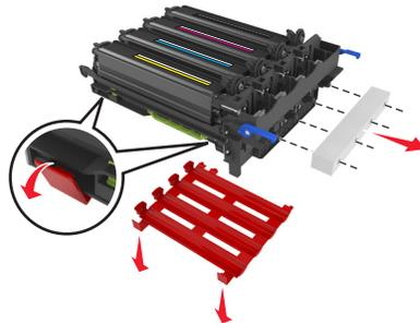
**警告—可能的损坏：** 请勿触摸成像组件下面发亮的感光鼓。否则会影响以后打印作业的质量。
