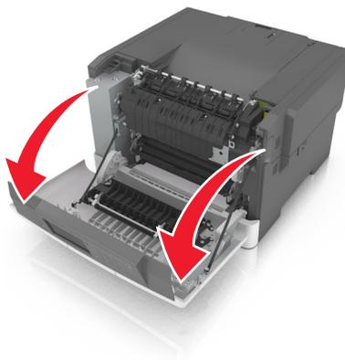
2 滑动打印机右边的释放插销，然后打开顶部盖门。
