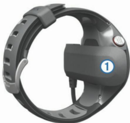
1. 将充电器上的USB插头插入电源适配器中或电脑USB接口中。
