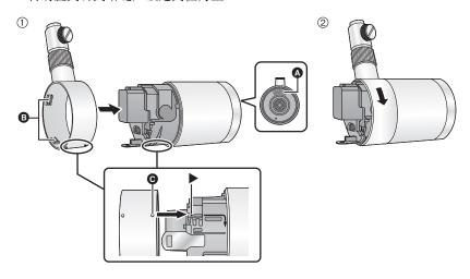
4 将各电缆穿过后盖,然后将其连接到摄像机机身的后部。
