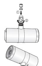
3 将三脚架安装到三脚架安装孔 页中。
