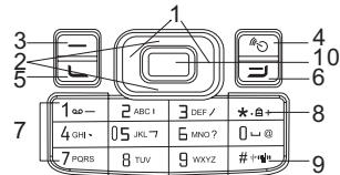
1.左右键：编辑时左右移动光标；待机状态，按左键进入多媒体菜单，按右键进入[信息]菜单；在照相机、摄像机预览状态，按左右键可调节曝光补偿参数。
