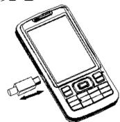
●将充电器的接口插入手机的充电接口。
