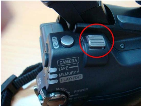
B. 攝影機開關的上方有一控制桿用於變焦，其按壓的力道可控制變焦的速度。
