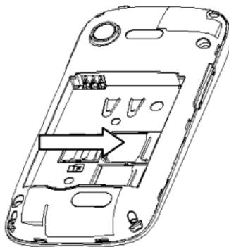
当您需要取出 **SIM** 卡时, 请先关机, 移去其他外部电源和电池, 再取出 **SIM** 卡。
