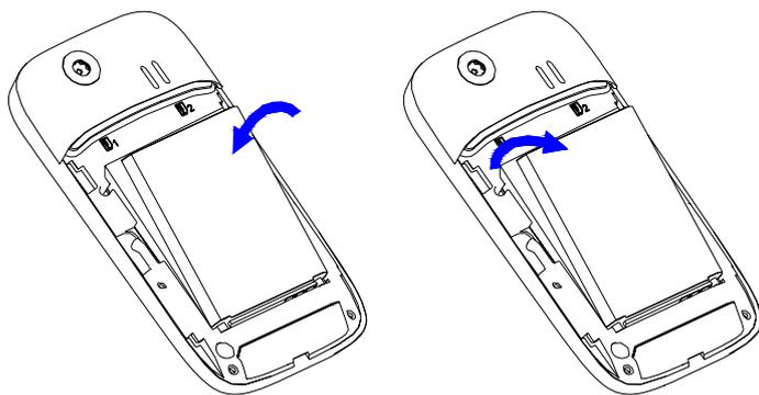
**警告：**拆卸电池之前一定要将手机关机并移去外部电源。绝对禁止在开机的情况下直接取出电池，否则可能损坏 SIM 卡和手机。
