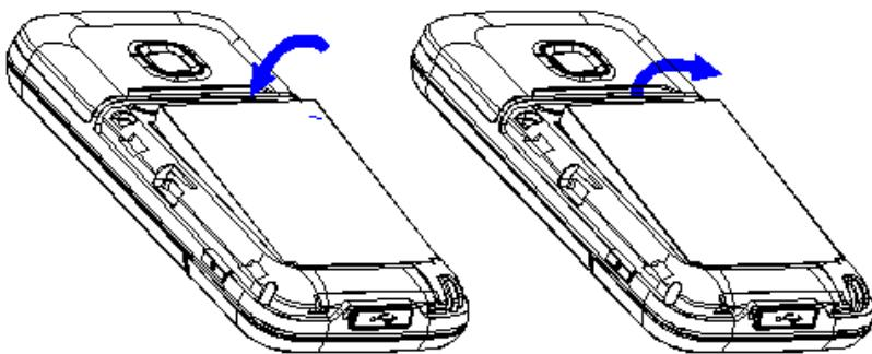
**警告：**拆卸电池之前一定要将手机关机并移去外部电源。绝对禁止在开机的情况下直接取出电池，否则可能损坏 SIM 卡和手机。
